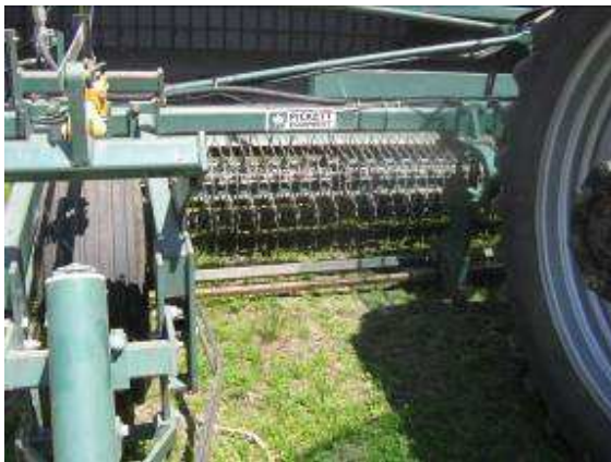
Figure 5. Le « Rod cutter », équipement servant normalement à récolter les haricots secs.
